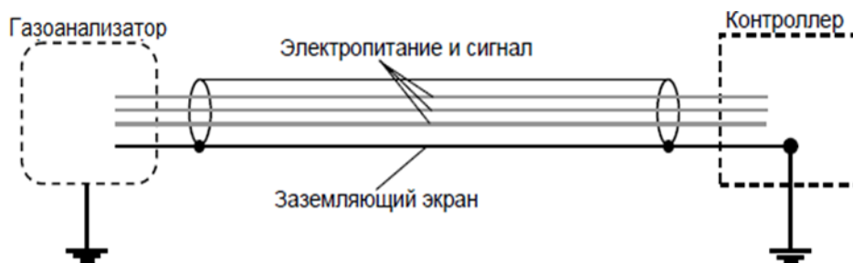
Рисунок 40 – Заземление экранированного кабеля
